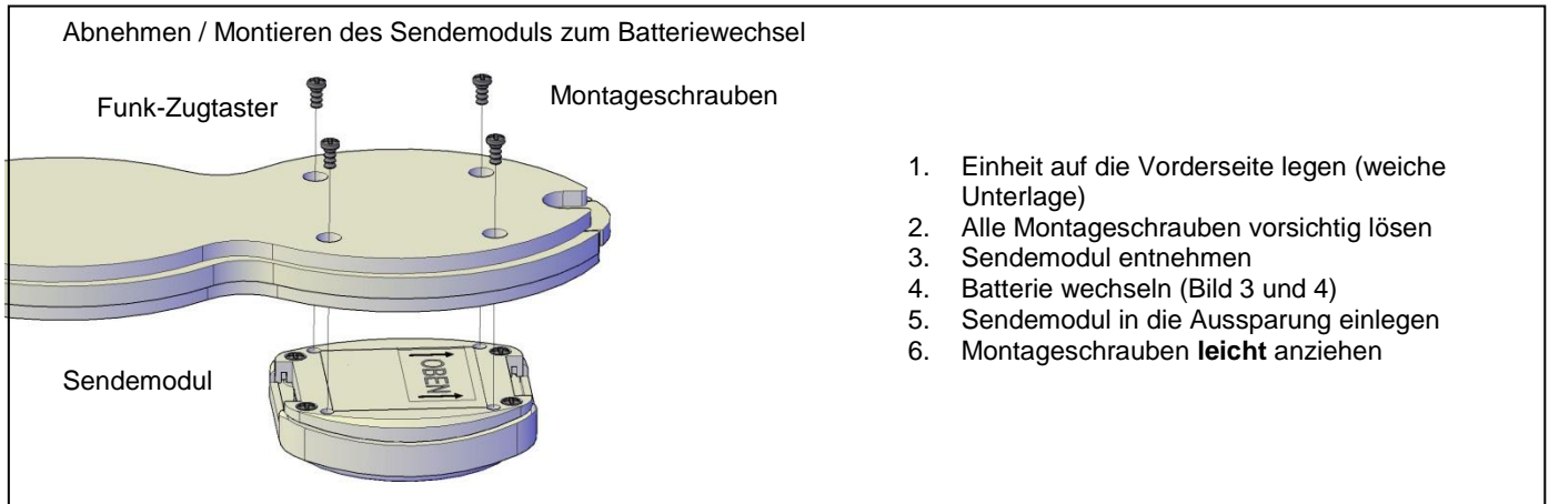
Bild 3: Einzelteil-Anordnung Sendemodul
