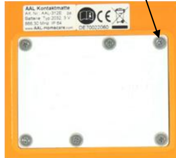
Abb. 1: Batterieabdeckung mit 6 St. Kreuzschlitzschrauben
